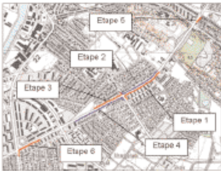
Støjskærme under udførelse langs Østre Ringvej og deres etapeopdeling.
